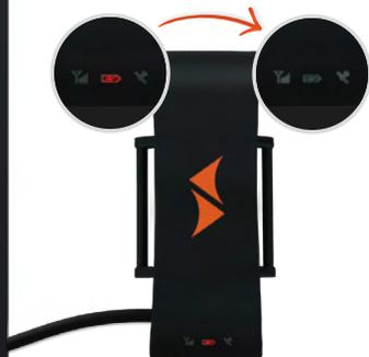
4. Attendere il completamento del processo di carica. Il dispositivo è completamente carico quando il LED rosso si spegne, vedere „1.11 Significato delle luci LED“ di questo manuale.
