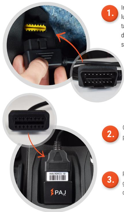
**1.** Inserire l'estremità della prolunga, che include i pin di contatto visibili, nell'ingresso OBD del veicolo finché non si incastra saldamente.
