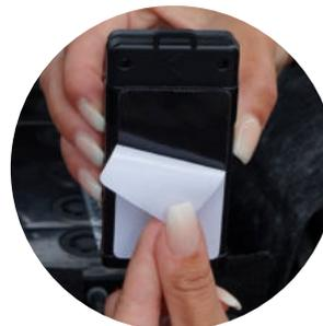
1. Montare il FINDER nel vano motore utilizzando la striscia adesiva
