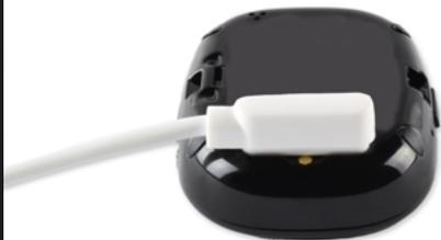
Prima di utilizzare il FINDER per la prima volta, è necessario caricarlo. Collegare la parte magnetica del cavo di ricarica al contatto magnetico del FINDER. Collegare quindi il connettore USB a un adattatore per presa a muro e inserirlo in una presa di corrente. Una volta collegato alla fonte di alimentazione, il FINDER si accende automaticamente. **Caricare il FINDER fino a quando il LED rosso non si accende in modo permanente.**
