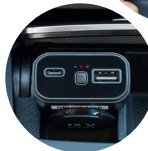
3. I LED si accendono quando il dispositivo è collegato correttamente
